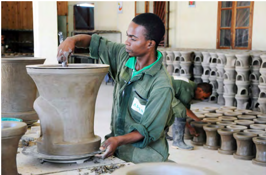
Fertigstellung der Ton-Brennkammer eines Energiesparkochers für Schulen. Das Projekt möchte neben der CO 2 -Reduktion die Abholzung vermindern.
